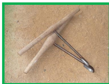
JE SUIS UN DES OUTILS LE PLUS IMPORTANT POUR FAIRE L'INTERIEUR DES SABOTS : LA CUILLERE
