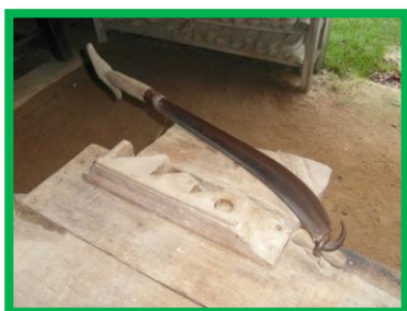
JE SUIS UN DES OUTILS LE PLUS IMPORTANT POUR FAIRE L'EXTERIEUR DES SABOTS : LE PAROIR
